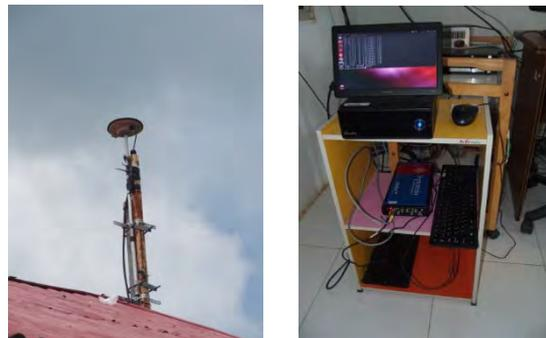
図 2. インドネシア・コタババンに設置した 3 周波 GNSS アンテナ(左)と受信システム(右)。
