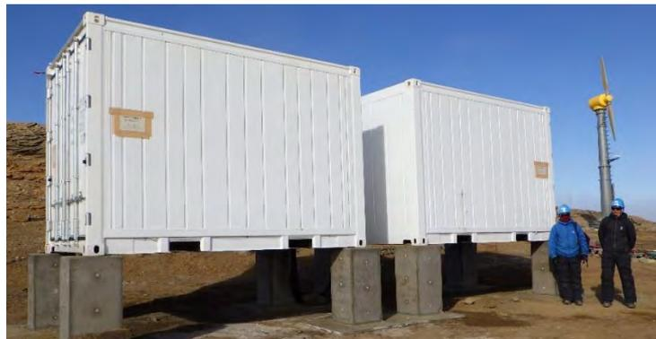
信州大学は国立極地研究所との共同研究により、2018年2月から南極昭和基地で小型ミュオン計 (2m<sup>2</sup>) と中性子モニター (NM64 with 6 BP28 tubes) による新観測を開始した (上図参照)。ミュオン計と中性子モニターは、一次宇宙線が大気中で生成する異なる二次粒子 (ミュオンと中性子) を検出するが、生成に必要な閾値エネルギーの違いにより、ミュオン計は中性子計に比べて約5倍高いエネルギーの一次宇宙線に最も高い感度を有する。一方で、二次粒子が大気中を伝播する際に起こす反応の違いにより、ミュオン計と中性子計で観測されたデータには異なる大気効果が含まれる。例えば、ミュオン計データでは、大気気圧効果が中性子計の約1/5である反面、中性子計データにはあまり見られない大気気温効果が目立つ。大気気温効果はミュオン強度に顕著な季節変動を引き起こすため、特に宇宙線密度 (強度の等方成分) の変動を解析する際には注意が必要である (Mendonça+ ApJ
